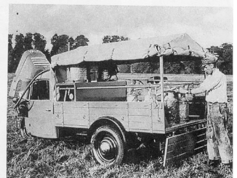
Das Goliath-Werk entwickelte in Zusammenarbeit mit der Westfalia-Separator AG aus den Dreirädern fahrbare Melkmaschinen.
